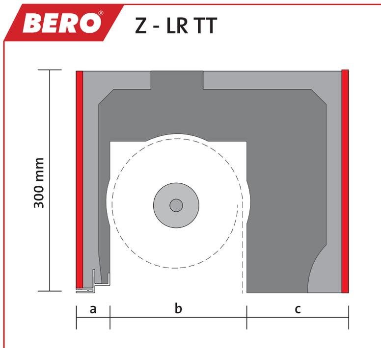
Selbsttragender Rollladenkasten aus bewehrtem BEROpor-Leichtbeton mit fest einbetonierten Ziegelblenden und einer **äußeren Montageöffnung** für einen linksrollenden Rollladen.
